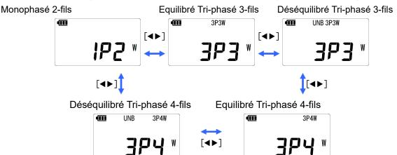
Appuyez sur le bouton mode pendant que la configuration de câblage souhaitée est affichée. La sélection est confirmée et l'affichage revient à l'écran de sélection.
