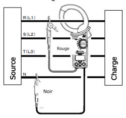
Appuyez sur le bouton de commutation des éléments [▶] après avoir établi la connexion, l'écran LCD affiche la puissance active de la phase R(L1). En appuyant sur le bouton de mode, l'indication commute entre la puissance active de la phase R(L1) et les valeurs efficaces de tension/courant.
