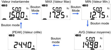
La portée est fixe alors que l'écran LCD affiche MAX, MIN, AVG ou |PEAK. La fonction de réglage automatique (auto-ranging) de la portée est réactivée lorsque l'affichage passe à la
