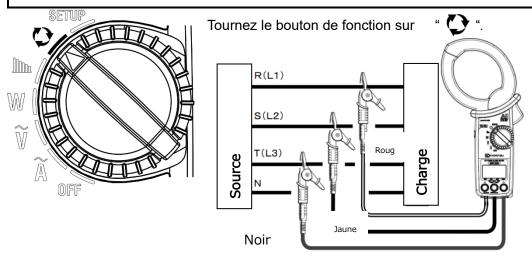
Selon le système de câblage des triphasés 3 fils et des triphasés 4 fils à tester, les résultats sont affichés comme le montre le tableau suivant. Chaque numéro représente l'ordre des phases connectées
