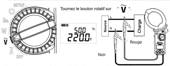
Une simple pression sur le bouton Mode : changement de mode d'affichage ......entre Inst, MAX, MIN, AVG, et |PEAK|.
