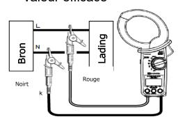
Lorsque l'unité affichée sur l'écran LCD est "A", cela signifie que l'écran est "l'écran de mesure des harmoniques de courant". Maintenez enfoncé (longue pression) le bouton de commutation des éléments [>] pour passer à l'unité "V".
